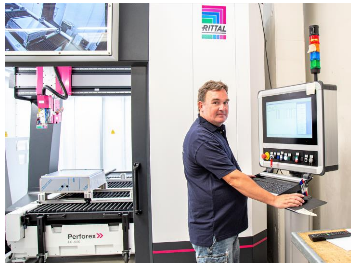
Maskinoperatør Michael Schwartz, Pro-Automatic A/S, kan styre og programmere laserbearbejdningscentret direkte på en maskinens terminal, og mens den arbejder, er det muligt at forberede det næste job.
